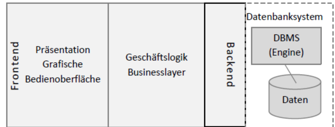
Abbildung 6-2 Aufbau einer Anwendungssoftware: 3-Schicht-Architektur
